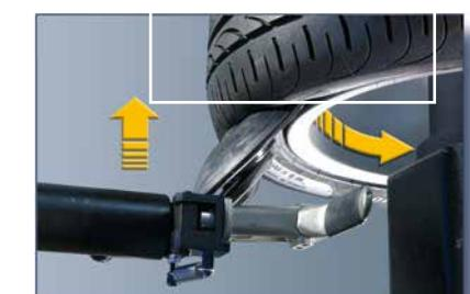
Il disco stallonatore del revolver preme idraulicamente sullo pneumatico e la contemporanea rotazione della ruota facilita la stallonatura superiore.
