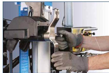
**LOWER BEAD DEMOUNT OPERATION WITH THE ASSISTANCE OF THE LOWER BEAD BREAKER DISC**
