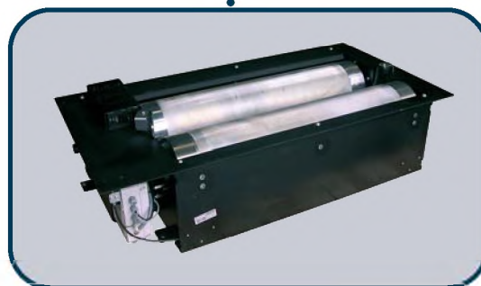
Banco a rulli PROVA VELOCITA' PV-06 "Master".
